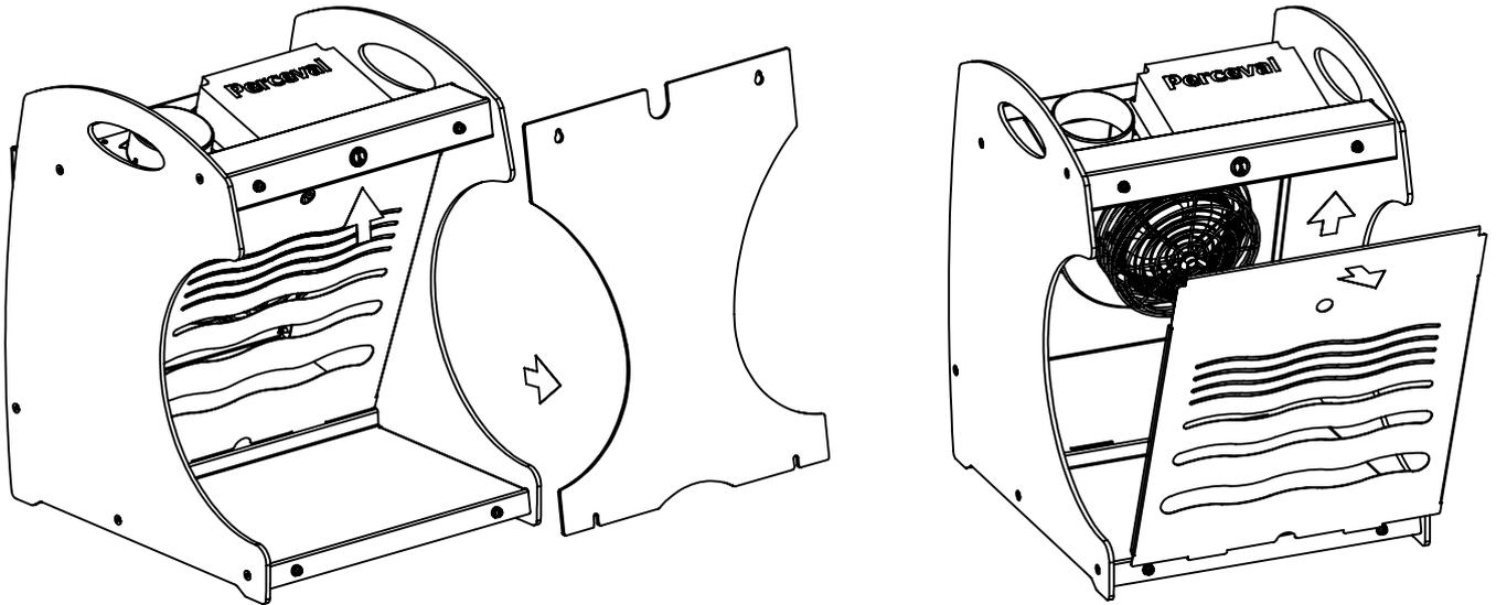
Dévissez l'écrou papillon qui maintient la cage du filtre.
