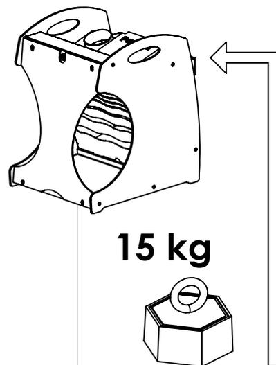
Pour l'accrochage mural, placez le support contre le mur pour que les 2 trous soient à la hauteur souhaitée. Notez que les trous sont situés à 40 cm au-dessus du plan de travail de l'appareil.
